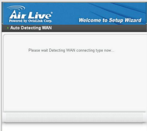
Pokud není bezdrátový router schopný zjistit druh internetového připojení, tak si nastavíte připojení ručně dle potřeby: Získání IP adresy automaticky, Pevná IP adresa, PPPoE, PPTP, L2TP nebo BigPond.
