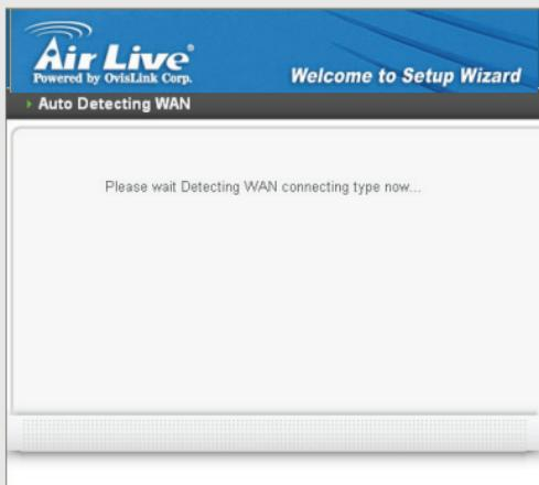
Se o Router WLAN não conseguir auto detectar a sua ligação à Internet, precisará de o fazer manualmente seleccionando o tipo de conexão de Internet : Obter IP automaticamente, IP Fixo, PPPoE, PPTP, L2TP ou BigPond.
