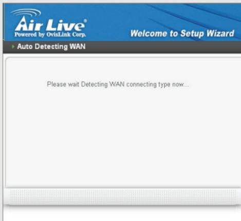
Falls die automatische Erkennung nicht gelingt, müssen Sie den Typ der Internetverbindung manuell auswählen: IP automatisch beziehen, Feste IP, PPPoE, PPTP, L2TP oder BigPond.
