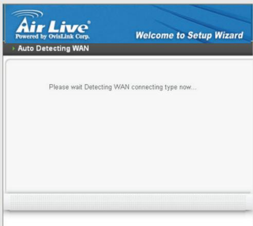
Если автоопределение не сработает, вам нужно будет выбрать тип соединения вручную: автоназначение IP-адреса, статичный IP-адрес, PPPoE, PPTP, L2TP или BigPond.
